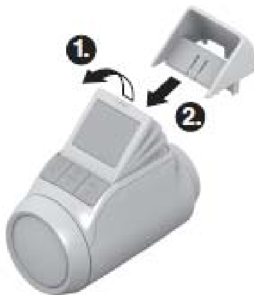
Displej lze v poloze 40° zaaretovat pomocí nástavce (nástavec je součástí balení)
